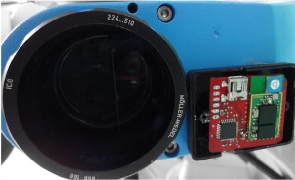
**Abbildung 4.7.:** Zur Kalibrierung der Achsen sechs und sieben dient ein Beschleunigungssensor neben der Linse. Kipp- und Neigewinkel werden per Bluetooth übertragen.
