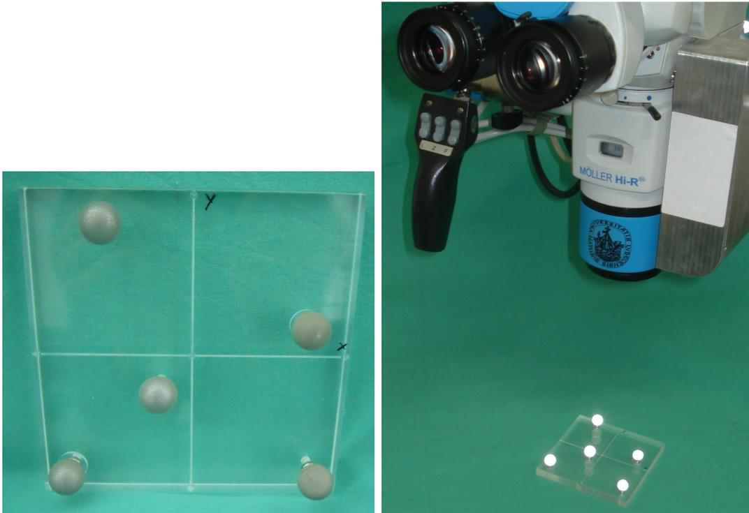
**Abbildung 3.9.:** Der passive Marker (links) dient der Bestimmung der fokussierten Position. Für den Versuchsaufbau (rechts) wird der Arbeitsabstand schrittweise verändert und jeweils der Mittelpunkt des Sichtfeldes bestimmt.
