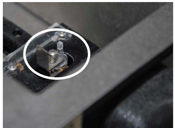
**Abb. 17** Messküvette (weisser Kreis) in abgesenktem Wasserbad
