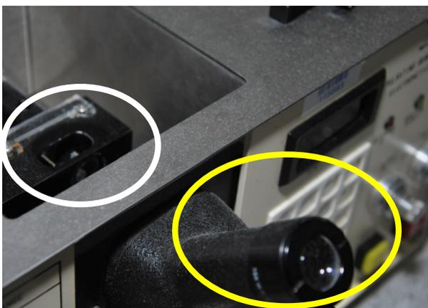
**Abb. 16** Messküvette (weisser Kreis) in meßbereitem Wasserbad. Justiermikroskop (gelber Kreis)
