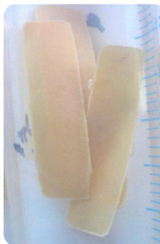
**Abbildung 11: Glutaraldehydfixiertes Rinderperikard nach dem Stanzen.**
