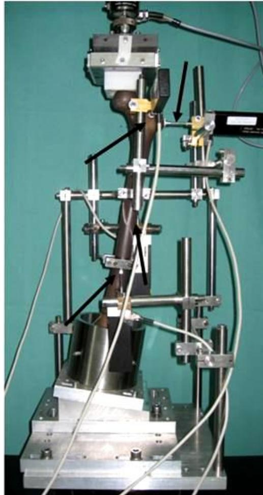
Abbildung 17: Messaufbau Axiale Kompression 9° (Pfeile = Tasterpositionen)
