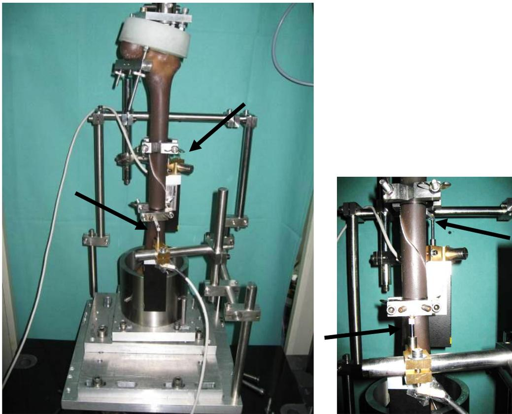
Abbildung 13: Messaufbau für die Axiale Kompression 0° (Pfeile = Tasterpositionen)
