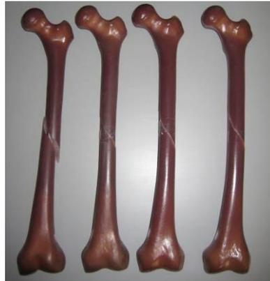
Abbildung 6: Kunstknochen der Fa. Sawbones mit langer Spiralfaktur (Fraktur jeweils mit durchsichtigem Klebeband fixiert)
