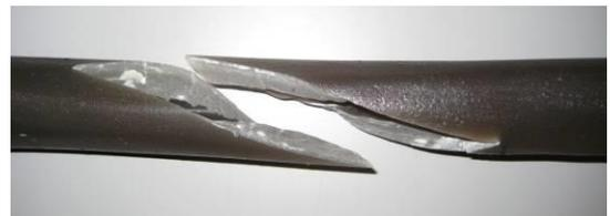
Abbildung 7: Spiralfaktur (AO 32-A1) von Fa. Sawbones (Schwarze Markierungen: kraniales und kaudales Ende der Fraktur)
