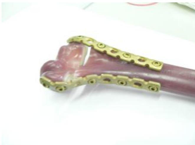
**Abb. 9:** Die Kleinfragment-Rekonstruktionsplatte am synthetischen Frakturmodell.
