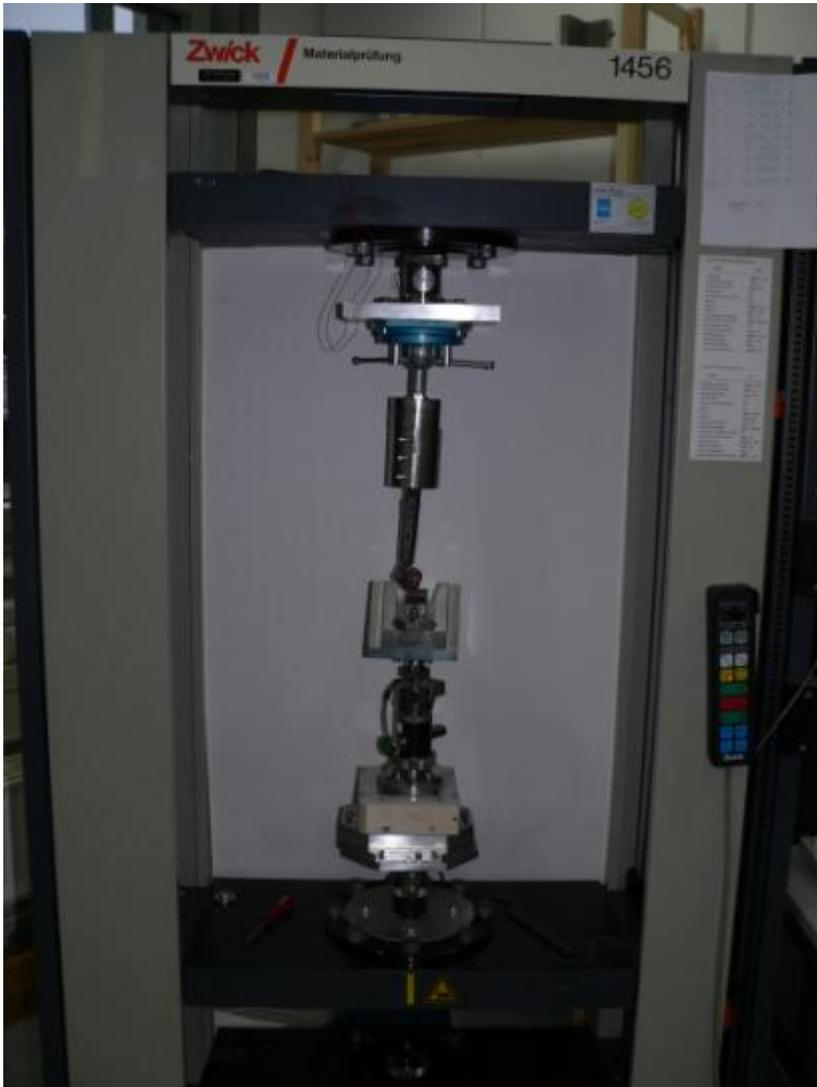
**Abb. 17:** Testaufbau zyklische Testung in Flexionsbelastung.
