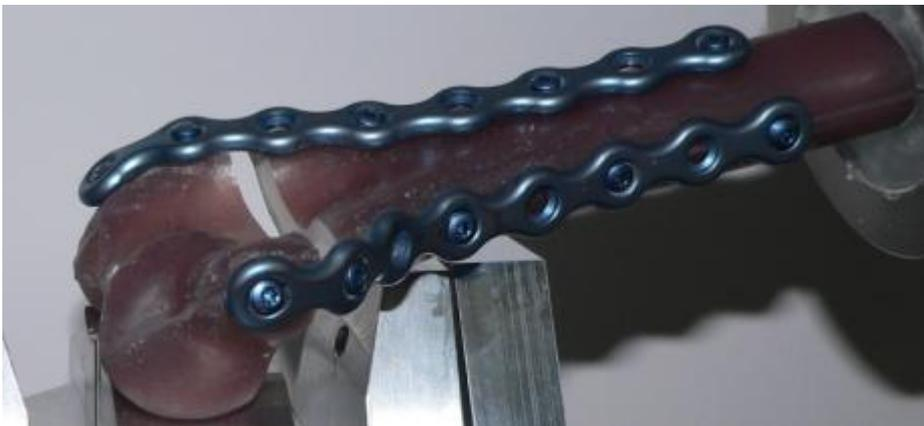
**Abb. 10:** Die Tifix-Platte am synthetischen Frakturmodell.
