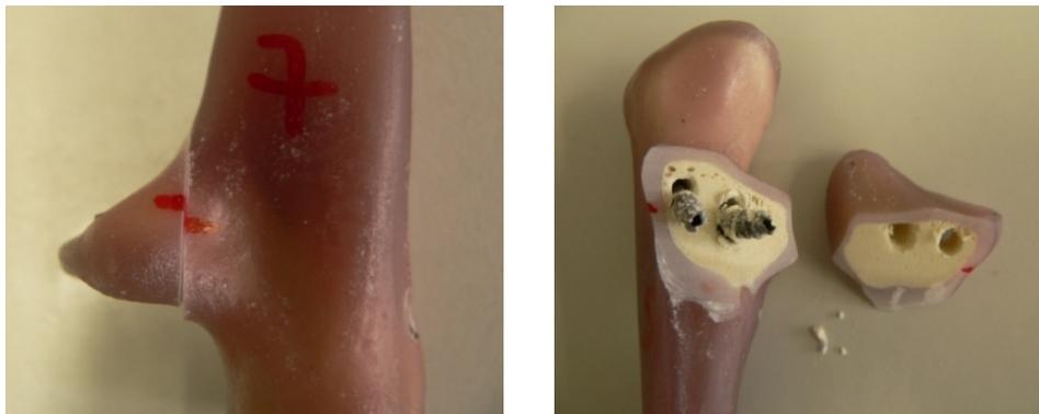
**Abb. 49 Versagensmuster der Schraubenosteosynthese: Fragmentverschiebung > 2 mm (links) und Auslockerung der Schrauben (rechts)**
