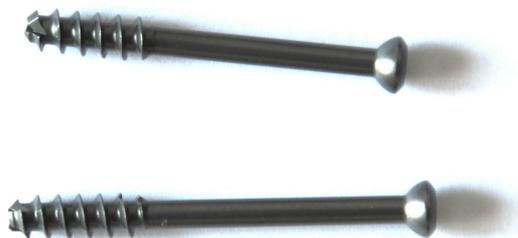
**Abb. 26 Kanülierte Schrauben** (Quelle: Biomechaniklabor Uniklinik Lübeck)
