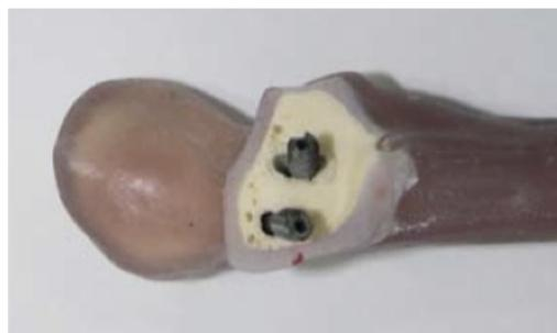
**Abb. 52 Zerstörungsmuster der Schraubenosteosynthese**
