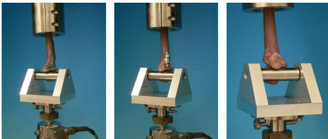
**Abb. 41 Die drei verschiedenen Osteosynthesetypen im Prüfstand**
