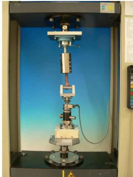
**Abb. 33 Kompletter Prüfstand mit eingespannter Probe für die quasistatische Testung** (Quelle: Biomechaniklabor Uniklinik Lübeck)
