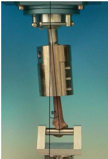
**Abb. 30 Positionierung des Kunstknochens im Prüfstand** (Quelle: Biomechaniklabor Uniklinik Lübeck)
