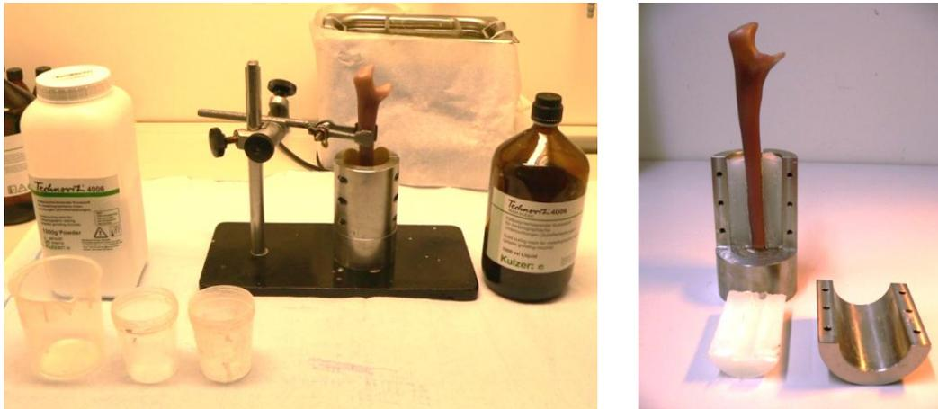
**Abb. 36** Anfertigung des Kunstharz-Negativabdrucks für die Probenaufnahme
