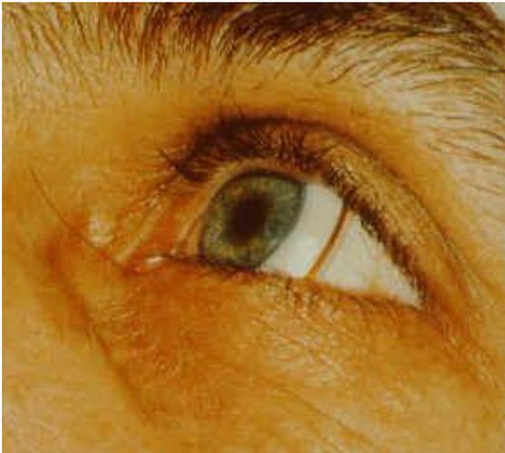
**Abb. 3:** Kontaktlinse des Search-Coil-Systems im Auge eines Probanden. Die Linse hat zentral ein Loch, eingearbeitet ist eine Spule aus dünnem Draht, der am medialen Augenwinkel aus dem Auge herausgeführt wird.
