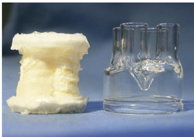
Abb.10: AVS-Halterung aus Gefäßstent, verbesserte Version aus Glas
