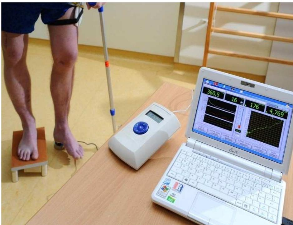
**Abbildung 4: Telemetrisches Messsystem zur Bestimmung der Knochenheilung mit am Oberschenkel angebrachter Antenne, Druckmessplatte, die unter der linken Ferse platziert ist, Lesegerät und Notebook-PC.**
