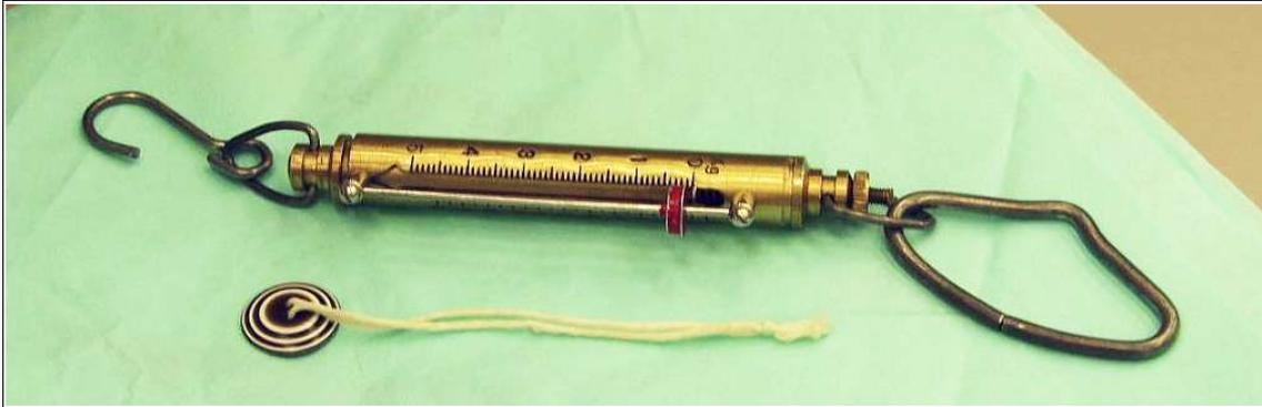
Abbildung 22: Federwaage zur Lippenkraftmessung
