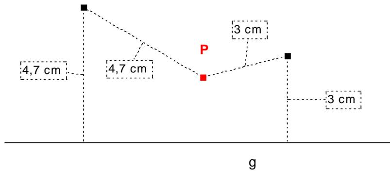
2. Konstruktion mithilfe konzentrischer Kreise und Parallelen zu  $g$ .
