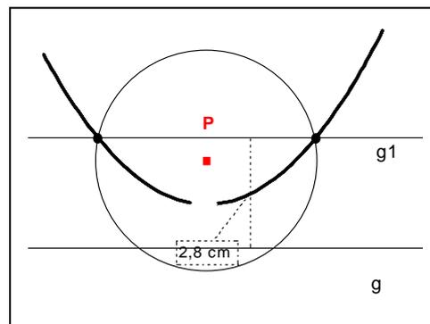
3. Wähle  $A$  auf  $g$ , konstruiere die Mittelsenkrechte zu  $|AP|$  sowie die Senkrechte zu  $g$  durch  $A$ . Der Schnittpunkt beider Geraden ist ein Parabelpunkt.
