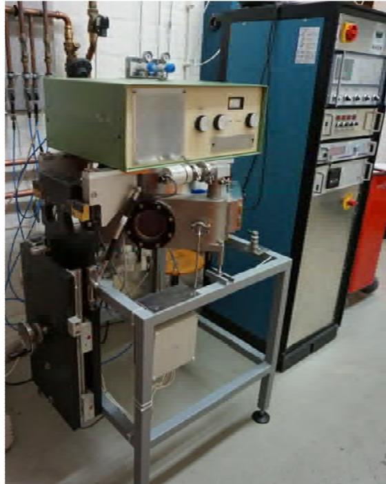
Abbildung 4.7: SPOCK-Sputteranlage links und Steuerkonsole rechts (Foto).
