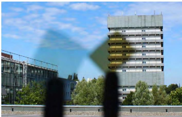
Abbildung 6.9: Demonstration der Farbveränderung bei der Erdalkalimetall-Dotierung von  $\text{VO}_2$  anhand des Fotos von Schichten aus undotiertem  $\text{VO}_2$  ( $\approx 80$  nm, rechts) und  $\text{V}_{0,918}\text{Sr}_{0,082}\text{O}_2$  ( $\approx 100$  nm, links), abgeschieden bei  $\vartheta_s = 550^\circ\text{C}$  auf Quarzglas.
