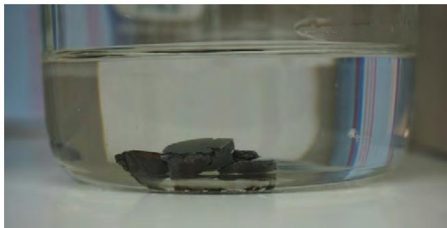
Abbildung 6.2: Metallisches Sr in Hexadecan (Foto).
