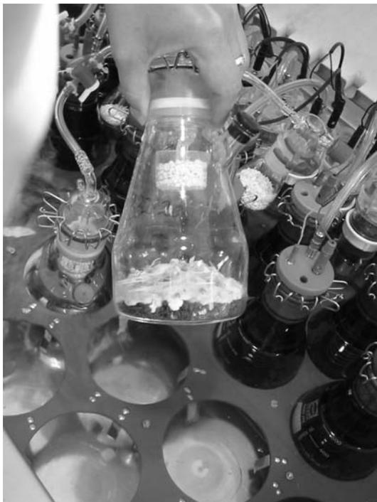
Abbildung 12 Versuchsreaktoren im Sapromatensystem D 12 (Voith, Heidenheim, Deutschland).
