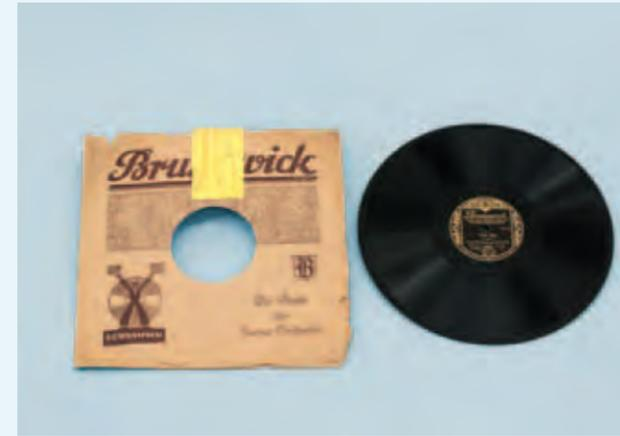
In der ersten Hälfte des 19. Jahrhunderts bestanden Schallplatten meist aus Schellack. Ein Naturprodukt aus Gummilack, das aus Ausscheidungen der Lackschildlaus gewonnen wird. Für ein Kilogramm Schellack werden rund 300.000 dieser Läuse benötigt.
