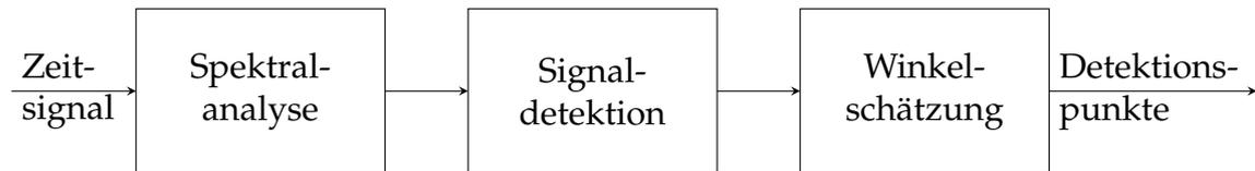
Abbildung 3.15: Blockdiagramm der digitalen Signalverarbeitung beginnend beim Zeitsignal im Basisband bis zu den Detektionspunkten, welche die Objektstreuzentren repräsentieren
