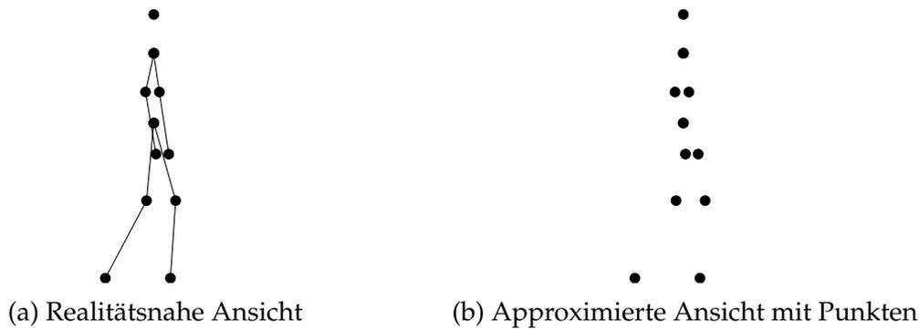
Abbildung 4.13: Punktmodell eines Fußgängers zur Verwendung in Radarsimulationen
