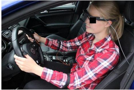
Abbildung 7.10: Versuchssetting der Realfahrt. Zur Erfassung des Blickverhaltens trug die Versuchsperson eine Eye-Tracking Brille von Ergoneers (Dikablis glasses 3, 2018). Druckknöpfe für die Erfüllung der Nebenaufgabe waren an beiden Daumen befestigt.
