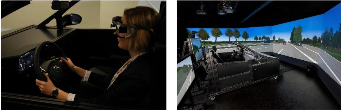
Abbildung 6.8: Statische Sitzkiste der Group Innovation der Volkswagen AG (links) vor fünf Leinwänden (rechts, mit Genehmigung der Volkswagen AG, 2020). Zur Erfassung des Blickverhaltens trug die Versuchsperson eine Eye-Tracking Brille von Ergoneers (Kansteiner, 2014). (Bauerfeind et al., 2022), CC BY 4.0, <https://creativecommons.org/licenses/by/4.0/>.
