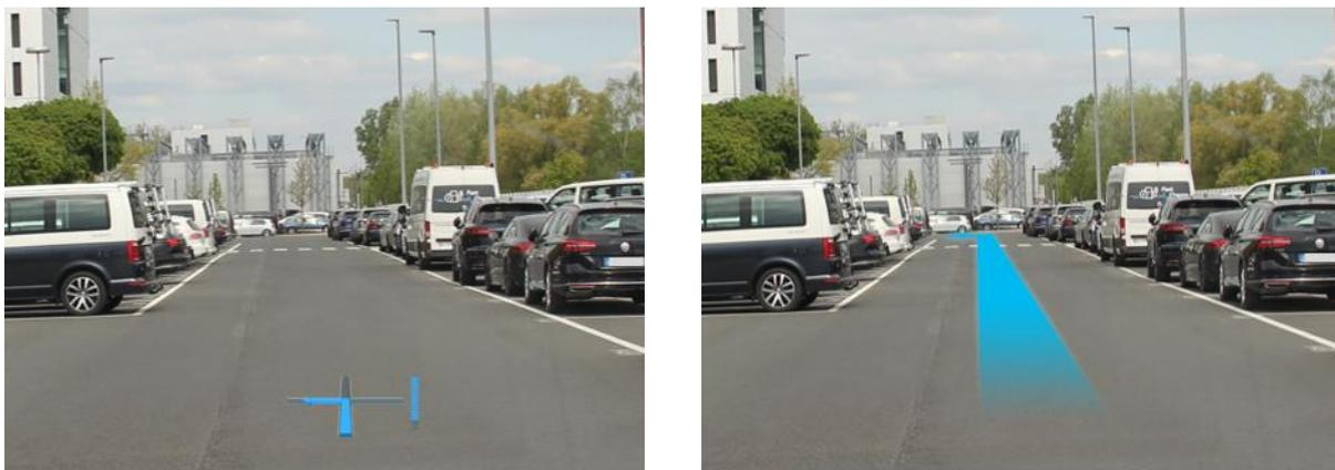
Abbildung 2.2: Navigationsinformationen in einem HUD vs. in einem AR Display - In einem HUD werden die Navigationsinformationen schwebend über der Motorhaube angezeigt (links). In einem AR Display werden die Navigationsinformationen positionsgenau in der Umwelt platziert (rechts).
