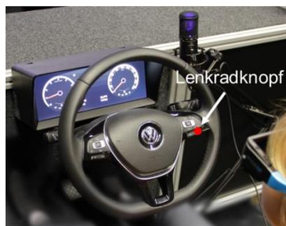
Abbildung 5.1: Lenkradtaste für die Nebenaufgabe - Der rote Punkt markiert die Lenkradtaste, die für das Ausschalten der Anzeige zur Erfassung des Entscheidungspunktes gedrückt werden musste (modifiziert nach Bauerfeind et al., 2019, Rechte bei den Autoren).
