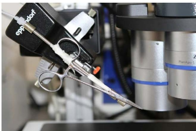
**Abbildung 56:** Aufbau der Zugversuch-Aparatur am Mikromanipulator. Die chirurgische Klemme wurde an den Mikromanipulatorarm geklebt und auf einen Winkel von  $45^\circ$  eingestellt.
