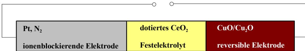
Abbildung 2.10: Verwendete Messanordnung.
